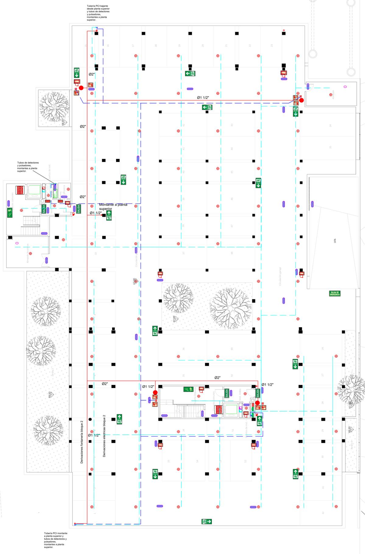
Tubería PCI bajante desde planta superior y tubos de detectores y pulsadores, montantes a planta superior.
