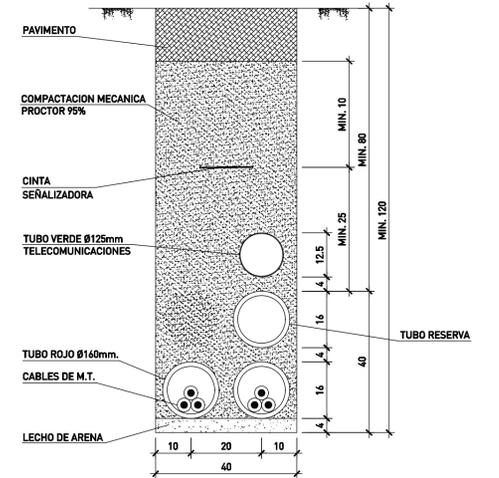
CANALIZACIÓN A BORDE DE CALZADA TIPO M4
