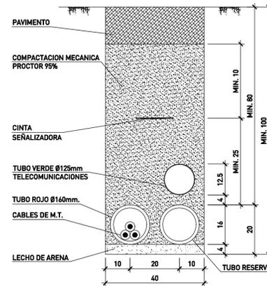
CANALIZACIÓN A BORDE DE CALZADA TIPO M3
