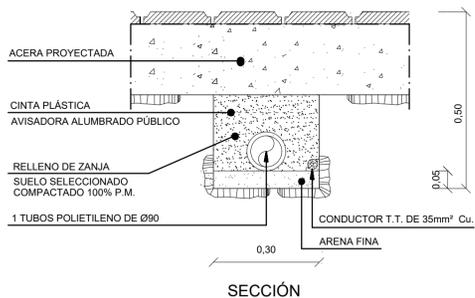
CANALIZACIÓN SUBTERRÁNEA ACERAS PAVIMENTADAS (2 TUBOS)
