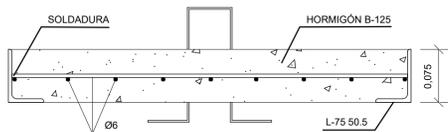
CANALIZACIÓN SUBTERRÁNEA ACERAS PAVIMENTADAS (1 TUBO)
